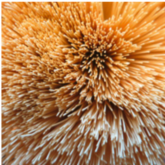
Bild 6: „Sepuran Green“-Module trennen effektiv das Methan vom Rohgasgemisch
