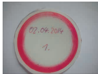
Bild 6. Gleichmäßiges Druckbild und ausreichende Flächenpressung von rd. 30 MPa
