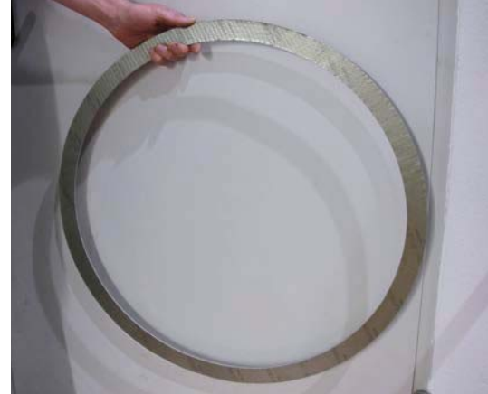
»1 Neue Dichtung für den Hochtemperatureinsatz
