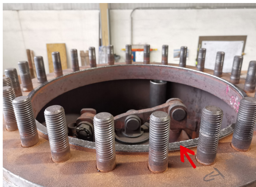
Bild 4: Geöffneter Dampfdom mit KLINGER®PSM Graphit Flachdichtung
