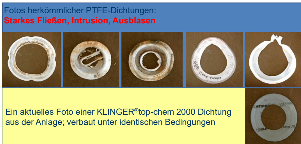
Bild 4: Beispiele von PTFE-Dichtungen mit mangelhafter Standfestigkeit
