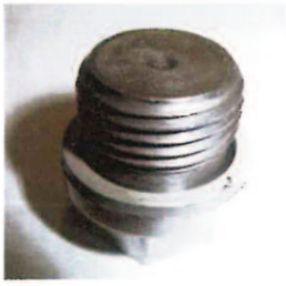
Bild 3: Dichtstopfen mit Dichtring an einer Chemiepumpe
